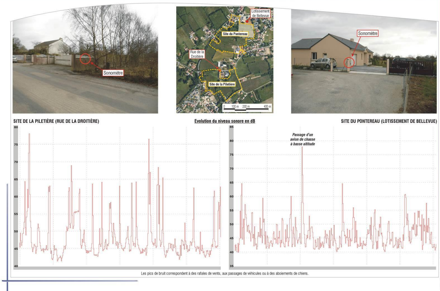
Figure 48 : Mesures acoustiques sur les sites de la Piletière et du Pontereau : localisation et résultats
